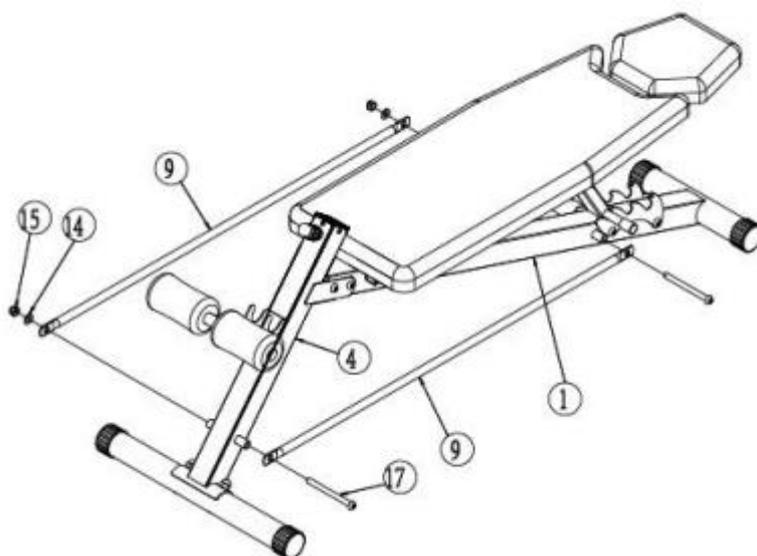
Připevněte opěry rámu (9) na rám nosníku (4) a hlavního rámu (1) pomocí šroubů (17), podložek (14) a matic (15).
