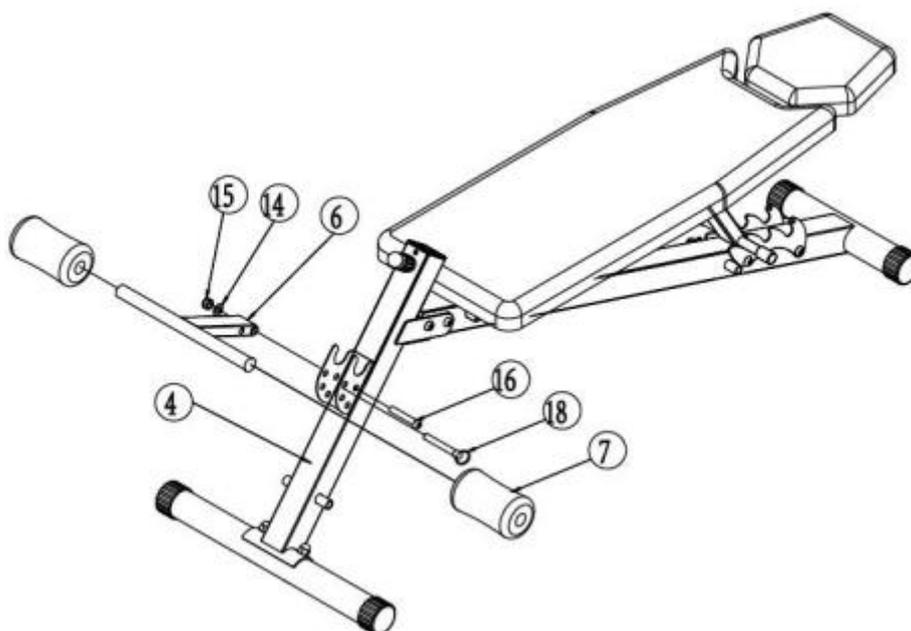
Připevněte rám pěnových válců (6) na přední rám (4) pomocí šroubu (16), podložky (14) a matice (15). Zajistěte rámy pomocí pinu (18).
