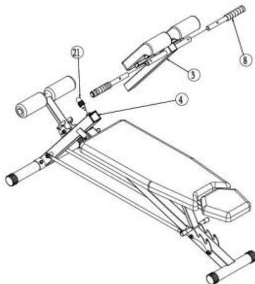
Připevněte madla (8) do rámu opěrky (3) a připevněte rám opěrky (3) do rámu nosníku (4) pomocí ručního šroubu (21).
