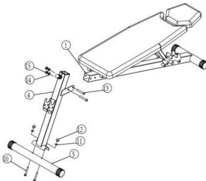
Připevněte rám nosníku (4) s nosníkem (5) pomocí šroubů (10), podložek (11) a matic (12).
