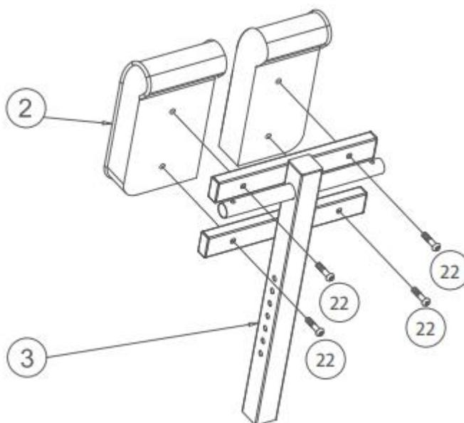
Připevněte opěrky (2) na rám opěrek (3) pomocí šroubů (22).
